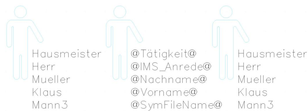
Die Abbildung zeigt auf der linken Seite ein Symbol mit ausgefüllten Symbolvariablen, in der Mitte des Bildes sehen Sie ein aufgelöstes Symbol mit den Platzhaltern der Variablen in SPIRIT 2019 und rechts das aufgelöste Symbol mit Texten in SPIRIT 2020.
